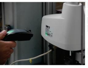
Barcode mit der Modell-und Seriennummer von Linaks Aktuator (Antriebselement) wird gescannt und die Prüfstation lädt über den PLCSQL Link relevante Daten aus der Datenbank.
